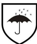
**Impermeabilidad al agua.** La norma especifica la presión de agua a la que se somete el material exterior y las costuras, obteniendo la resistencia a la penetración del agua, utilizando el valor para clasificar el EPI en una de tres Clases, que van de 1 a 3, de menor a mayor estanqueidad. Este valor se coloca en la parte superior del pictograma.
