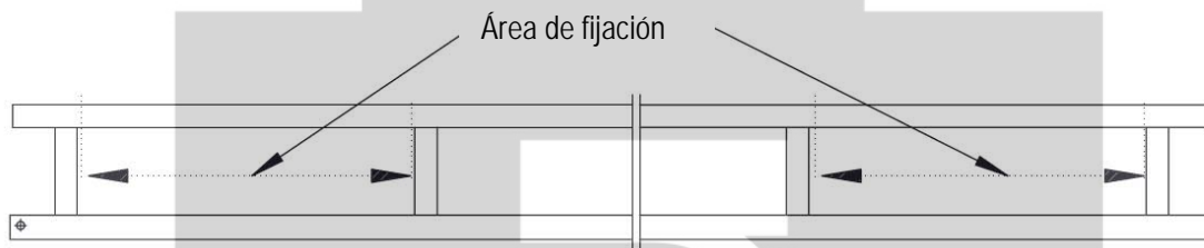
Fig. 5-1. Tramo de carril con el área de fijación
