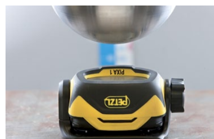
Ensayo de resistencia a los golpes
