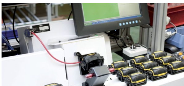
Ensayo individual de rendimientos de iluminación
